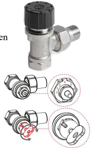
D'une tête thermostatique à bulbe incorporé de technologie liquide, modèle R469H fixation M30X1.5mm, Coefficient de variation temporelle de 0.2 K. Plage de réglage de 8 à 28° C, avec possibilité de limitation ou du blocage de la consigne.
